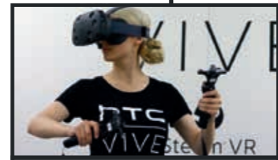
2015 HTC Vive Mit Hilfe der 360° Tracking-Technologie Lighthouse des Herstellers Valve können sich Nutzer in einer virtuellen Umgebung bewegen und dort in Echtzeit miteinander interagieren.
